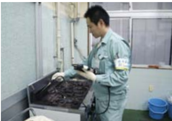
[13 A ガスの燃焼確認作業を実施] 業務用レンジの排ガス測定、ゆで麺器の正常な燃焼を確認しました。
